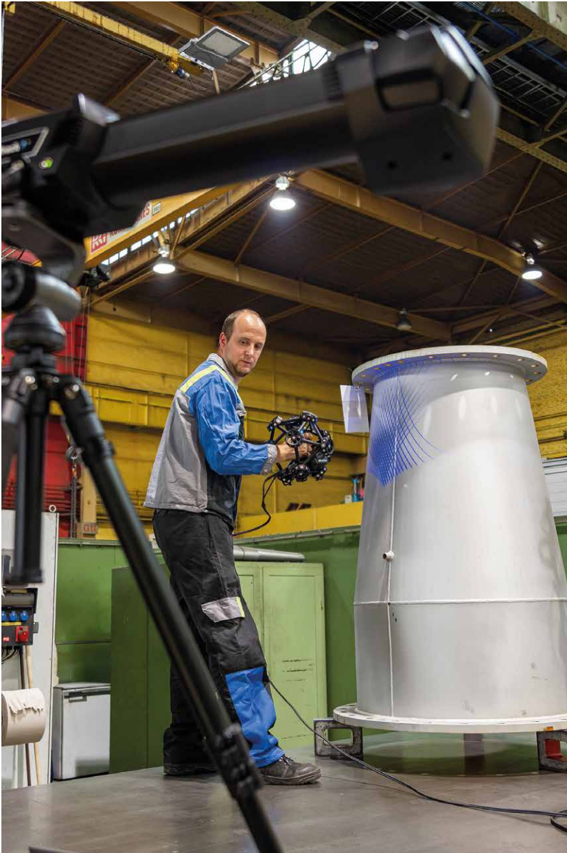
Bild 1: MetraSCAN 3D beim Scannen eines (glänzenden) Rohrsegments einer Hochofenanlage.
