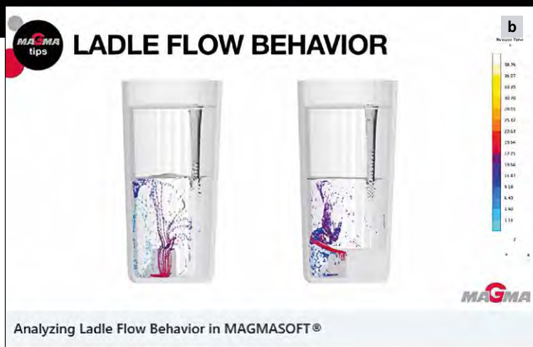
Bild 5: Beispiele für Gussimulation; a) Formfüll- und Erstarrungssimulation, b) „Ladle Flow“.
