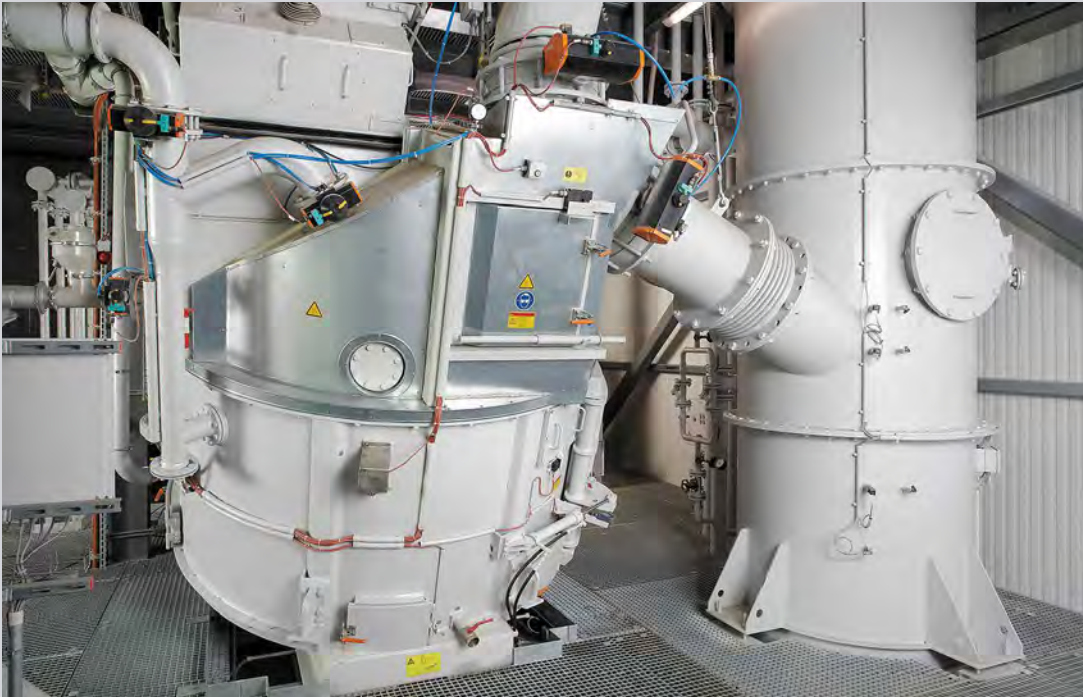
Bild 1: Evactherm-Mischer, Kühlen – Aufbereiten – Mischen in einem Aggregat.
