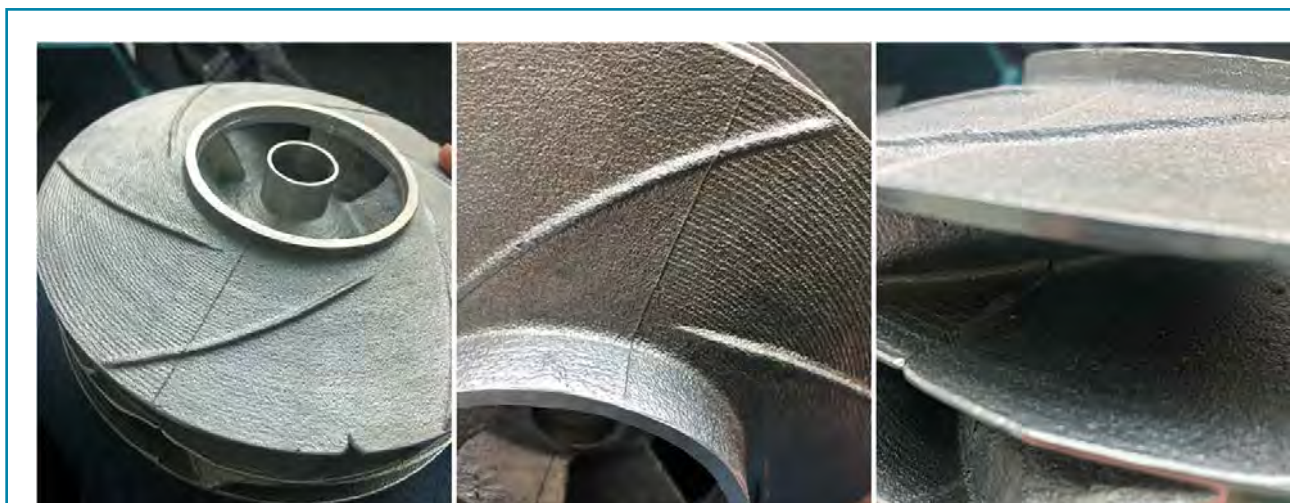
Bild 6: Gegossener Impeller mit jeweils geglätteten und konventionellen Oberflächen im Vergleich.
