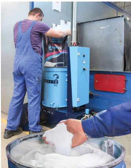
Bild 4: Der automatische Dosierer Injecto 05 wird mit einem speziell abgestimmten Reinigungsadditiv befüllt.
