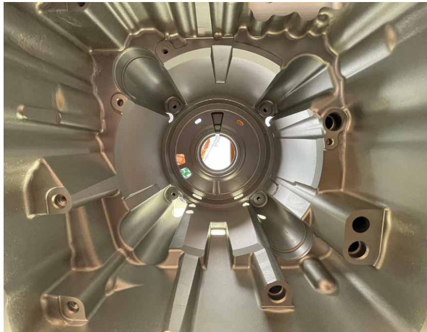
Einfach schön: Gegossenes Getriebegehäuse, Innenansicht
