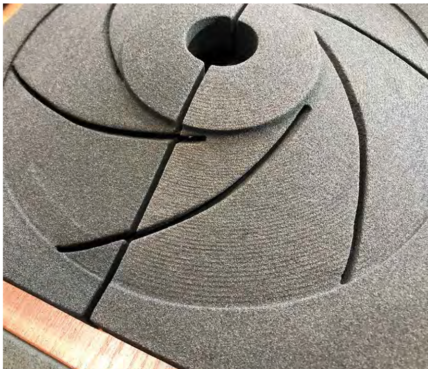
Bild 5: Parametrisierte (linke Hälfte) und konventionell (rechte Hälfte) gedruckte Gießform mit komplexen Flächen aus Furanharz.
