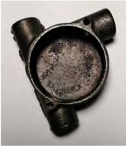
Bild 11: Schaltdose mit zwei Gewindelöchern und einer Stahlkappe aus GJL, aus dem Jahr 1925!
