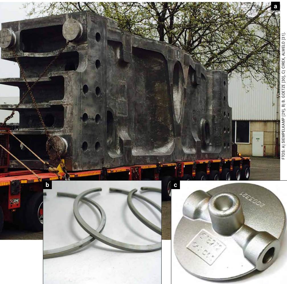
Bild 9: GJS-Bauteile gibt es in allen Größen und Zusammensetzungen; a) Laufholm für eine 500-MN-Metallumformpresse aus GJS-400, b) Kolbenring aus EN-GJS-600-3, c) Abgasrückführungssystem aus Ni-Resist D-5S.
