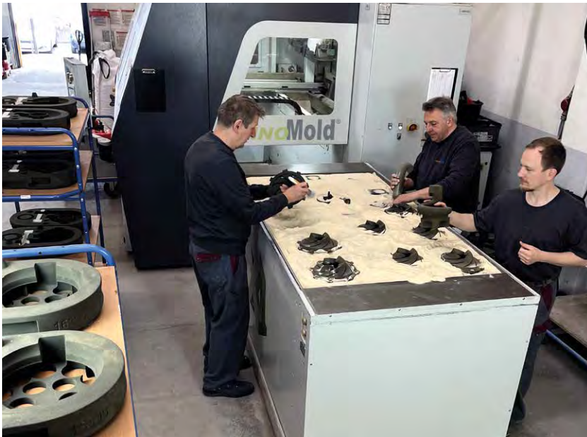
Bild 2: Die fertig gedruckten Sandkerne werden aus der Job-Box entnommen.
